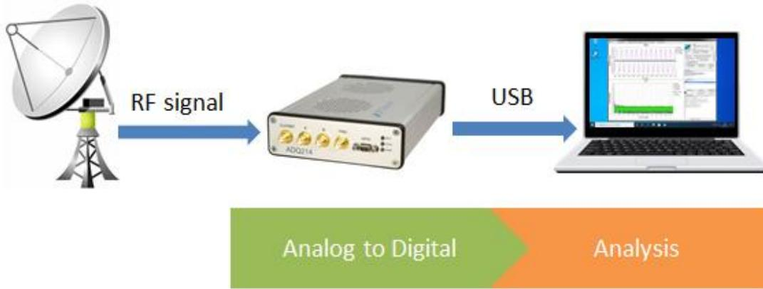
レーダの信号取得例です。レーダからのRF信号を「USBBOX」で取得し、デジタル化したデジタルデータをUSB経由でホストPCに転送します。記録データはオフラインで解析することが可能です。
