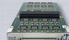
ACQ424ELF (1MHz 16bit 32ch A/D)
