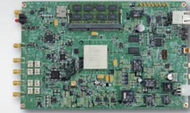
Xilinx社 Zynq 搭載高速 A/D&D/A ボード。AD は 1GHz 14bit 1ch, DA は 1GHz 16bit 4ch を搭載。
