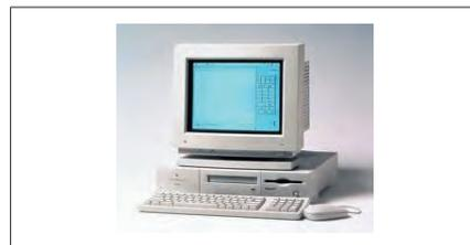
PowerPC は Intel の CISC 系 CPU とは異なり RISC の技術をベースに設計されている為、性能の割に低消費電力でサイズも小さいという事から、Power Mac の他にゲーム機やネットワーク機器又は組み込みシステム用の CPU ボード等に広く使われるようになりました。
