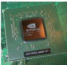
GPU とは Graphics Processing Unit の略で、コンピュータの画像表示機能を行うグラフィック・アクセラレータから発展した画像処理や演算処理を行うプロセッサの事です。
