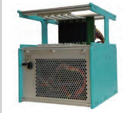
写真は ApisSys 社製 3U OpenVPX の 5 スロット開発シャーシです。バックプレーンはデータ・プレーンに 4 本の FP をルーティングしており全てのスロット間で PCIe x4 の通信が可能となっています。
