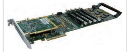
ANSI/VITAではこの互換性の問題について、ANSI/VITA 57.2でFMCの配置およびパフォーマンス・ケイパビリティの自動認識を提供するためにメタデータ・スタンダードを定義します。また、ANSI/VITA 57.3は、FMCモジュールと通信するために使用されるキャリアカードFPGAに実装するロジック・インターフェイスを定義します。ANSI/VITA 57.2及び57.3によって様々なFMC製品が、今後自由に搭載できる事を期待しています。
