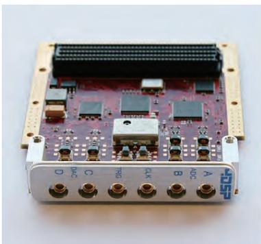
写真は4DSP社のFMC150というアナログI/O FMCモジュールです。FMCは名前の通りFPGA用のI/Oとして規格化されました。従来はPMC又は
