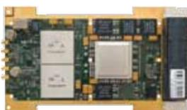
AV101は5GHzのA/Dをデュアルで搭載し、インターリーブにより10GSPSを実現した超高速のA/D&FPGA信号処理ボードです。RF帯域は3GHz未満を取得する事ができ、後段のFPGAで信号処理を行う事が可能です。カードはVPX (VITA46) に対応しておりバックプレーンを通して高速通信ができます。図21にブロック図を示します。
