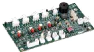
ファンの速度を調整すると、さまざまな利点があります。ファンの回転数を下げると、ファンの寿命が延びるだけでなく、フィルタの清掃のためのサービス間隔も長くなります。また、ファンの速度を遅くすることでシステムのノイズがはるかに少なくなります。
