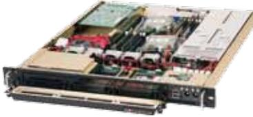
CP Technologies社のM1U2012は、ミリタリグレードの1Uラックマウントコンピュータです。温度範囲は0～40℃に対応し、輸送時の振動や衝撃に耐えられるよう独自の筐体設計を行っています。フロントベゼルには防塵フィルタが装備されていますので軍事車両への搭載にも適しています。また、独自の熱管理システム「SysCool®」により、計算機の寿命を延ばし消費電力を削減することができ、同時にシステム全体のノイズレベルを下げます。航空機、陸上車両、艦船、監視システム、UAVなどの用途に適しています。
