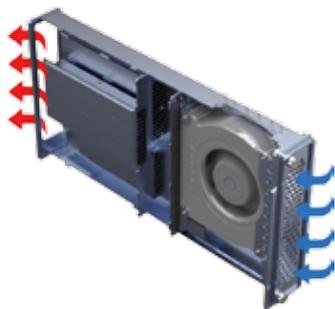
ファンをプレナムに組み込むことでヒートシンクを通る空気の流れが確実になり、優れた冷却ソリューションが得られます。これは、駐機場でアイドリングしている航空機や、砂漠を走っている軍用車両など、暑い環境で動作するシステムに適しています。しかし、低気圧での航空機ポッドや北極圏を飛行する無加圧UAVなど、寒い環境はどうでしょうか。RF信号レコーダが非常に低い温度で動作することも同様に重要となります。
