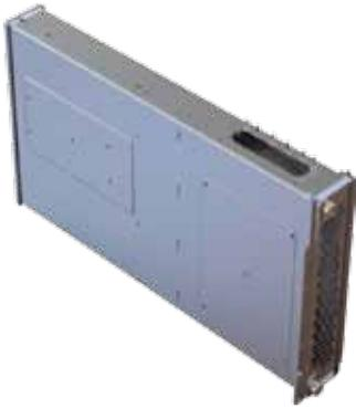
この場合、プレナムチューブを使用することで、シャーシ全体に空気経路を作り、より効率的な冷却効果を実現できます。プレナムチューブの壁に統合されたカスタムヒートシンクは、電子機器のすべてのヒートシンクを通して空気を直接流すことで、最高レベルの冷却を実現します。これにより、すべてのシステム電子機器を適切に冷却しながら外部環境から密閉されたままにすることができます。
