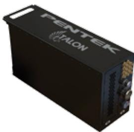
Pentek社のModel RTX 2586は、200 MHz, 16bit, 4chのA/Dコンバータを搭載した1/2 ATRタイプのデータレコーダです。記録容量は最大で30TBのSSDをサポートしています。サイズは195x124x359mmで、重量は約10kgとなっており非常にコンパクトな設計となっています。動作温度は-40～+60℃をサポートしていますので過酷な環境で使用することができます。航空機、艦船などへの搭載や無人機(UAV, UGV, UUV)への搭載用途に適しています。
