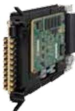
Pentek社のModel 5950はZynq UltraScale+ RFSocを搭載した3U VPXタイプのFPGAボードです。RFSoc FPGA内に4.0GHz 12bit 8ch A/Dと6.4GHz 14bit 8ch D/Aを内蔵しています。更に、
