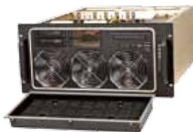
ミリタリ用コンピュータとオフィス用コンピュータとの主な違いの1つは冷却です。ミリタリ用コンピュータは通常、電源内のファンに加えて、1~4個の空冷ファンを装備しておりフロント側のエアフィルタで砂や埃の進入を防ぎます。一方、一般的なオフィス用コンピュータは、冷却のためのファンは電源内に1つだけです。ミリタリ用コンピュータは、砂や埃の侵入を抑えるためにシャーシ内に正の圧力をかけていますが、オフィス用コンピュータは、負の内部圧力で動作しているため、埃が内部に入りやすくなります。
