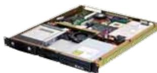
先に述べましたが、シャーシのインピーダンスつまり通気抵抗は、エアフィルタと出入り口の開口部の数、およびそれらのサイズと形状によって大きくなります。標準的な1Uシャーシでは、40CFMを確保するために40mmファンを4個搭載するスペースがありますが、最大圧力はわずか0.25インチです。シャーシインピーダンスでは、その流量はシャーシを通過して15～20CFMに低下します。一方、97x33mmのプロワーは1.00インチで25CFMを流すので、実際の空気流は約20CFMとなります。風量は殆ど同等ですが、プロワーは安価で静かになります。40mmファンには、このような用途のため良好な圧力を提供するものもありますが、非常にうるさくなります。
