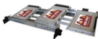
Red Rock製VPXストレージボードは、NVMe SSDを搭載したVPXタイプのストレージボードです。容量は最大32TBで、
