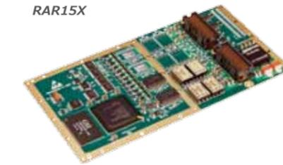
RAR15Xは、単一カードで高密度のMIL-STD-1553およびARINC 429チャンネルを提供し、SWaPの削減に役立ちます。最大4チャンネルのデュアル冗長多機能MIL-STD-1553と最大18チャンネルのARINC 429に加えて、オプションのフロントまたはリアI/O接続を備えたXMCカードで汎用アビオニクス機能を提供します。
