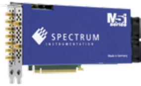
M5iシリーズは、最大6.4GHz 12bit 2chでサンプリング可能な高速A/Dボードです。入力帯域幅は最大2GHzをサポートしており、超広帯域の信号取得に
