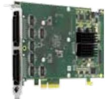
M2p.7515-x4は、125MHz 32chのPCI Expressタイプ高速デジタル入出力ボードです。最大125MS/sのレートで高速デジタル信号を取得及び再生することができます。入出力の方向はソフトウェアによって切り替えることができます。オンボードメモリは1GBを搭載しており、FIFOモ
