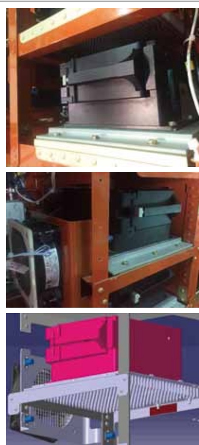
図 19. 外気冷却による伝導冷却の設置例
