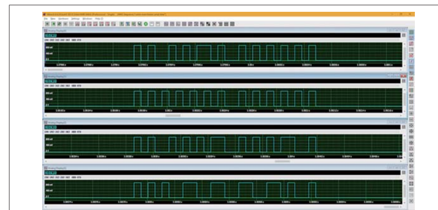
図 22. AWG 波形メモリに保存されているこれら 4 つの異なるマンチェスター符号化シリアルデータ
