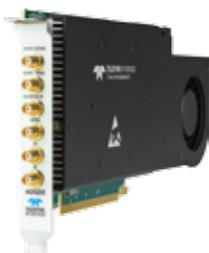
ADQ35-WBは、10GHz 12bit 1ch (又は5GHz 12bit 2ch)のサンプリングレートで最大9GHzのアナログ入力帯域幅を備えた広帯域の高速A/Dボードです。
