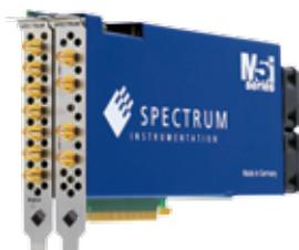
M5i.6357-x16 は、10GS/s の D/A コンバータを搭載した任意波形ジェネレータ (AWG) ボードです。 サンプリ
