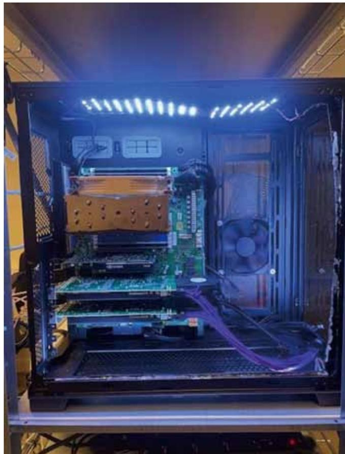
Figure 27 : 2枚のADQ35をインストールしたテストPC
