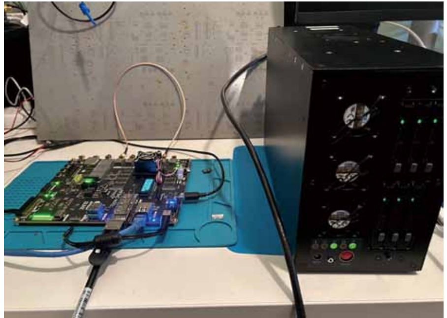
Figure3 : RFSoc と 100GbE レコーダの接続
