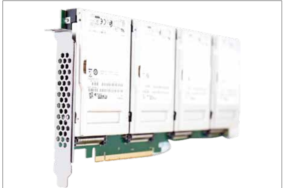
Figure33 : ドライブあたり 15 テラバイトをサポートする 4つの Kioxia CD8 NVMe エンタープライズ クラス SSD モジュールを搭載した PCIe-NVMe アダプ タボード
