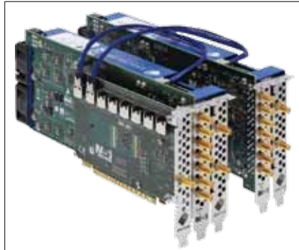
Figure18 : 2枚のM5iシリーズデジタルタイザの一般的なStar-Hubオプション。搭載されたStar-Hubボードとトリガー信号およびクロック信号をインターフェイスする同軸ケーブルセットを示しています
