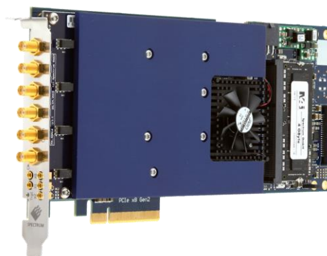
Figure 2 Spectrum M4i.2230-x8 デジタイザカードは、500 ps という短いパルスの取得に最適で、搭載されている FPGA で 3.4 GB/s データ転送を提供する
