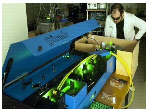
Figure 4 ラトロブ大学で開発された REMPI ベースの質量分析計 (左上) によって使用されるレーザーシステム (手前)
