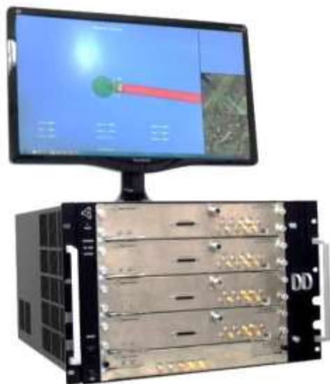
Figure 6 2台のGT-ASM18A(アップコンバータ)と2台のGT-ASAM18A(ダウンコンバータ)で構成される4チャンネルシステム
