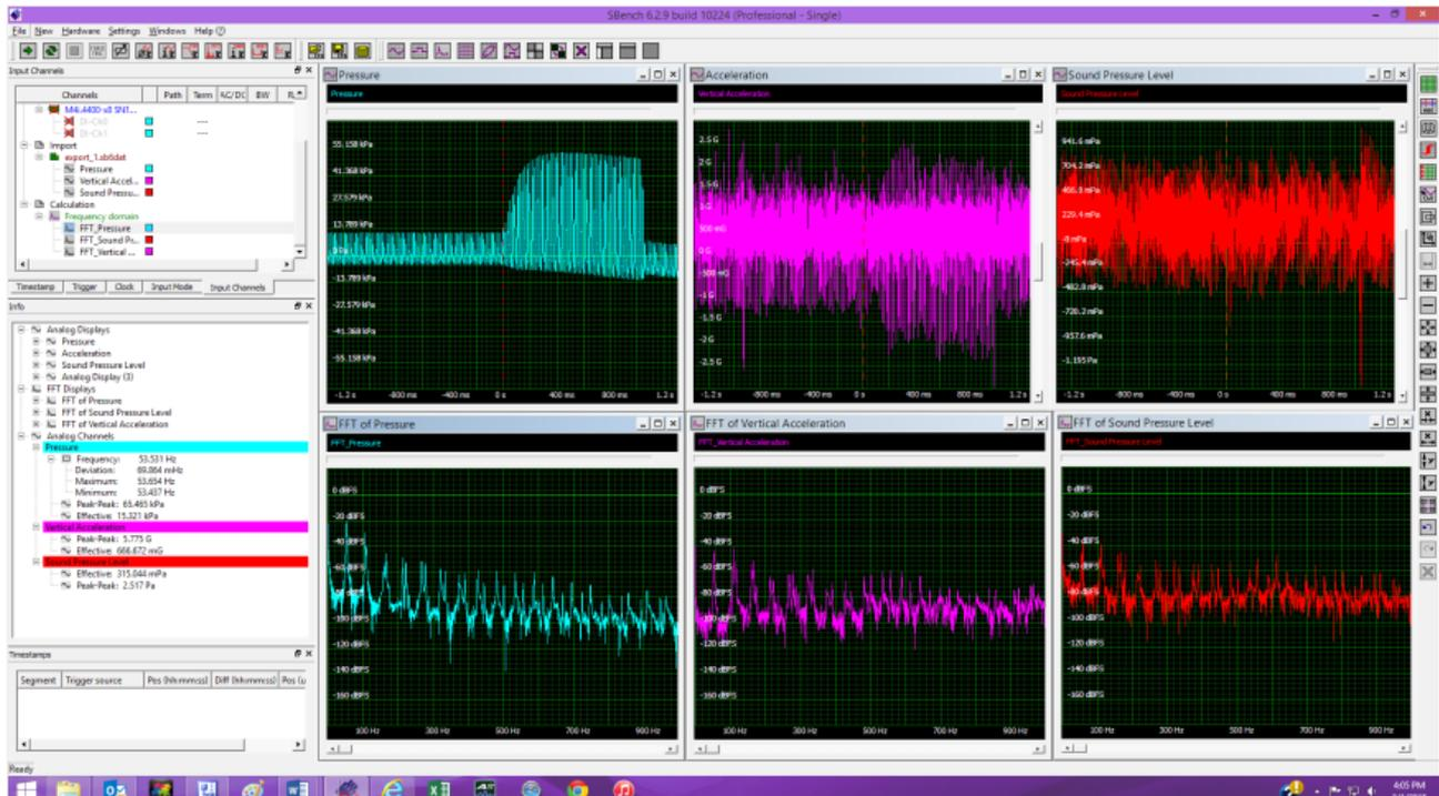
Figure 6 小型空気圧縮機の圧力、振動、および音のレベルを測定し、出力ポートをブロックする効果を示します。上部の3つのグリッドには、圧力、振動、およびサウンドレベルが（左から右に）表示され、関連するFFTがそれぞれ下に表示されます。
