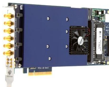
Figure 2 M4i.2212-x8 デジタイザは、最大 1.25GS/s のサンプリングレートで 4 チャンネル同時に信号をサンプリングし、取得したデータを最大 3.4GB/s の高速 PCIe バスで転送できます
