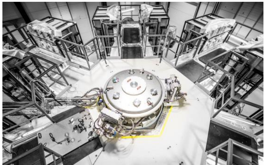
Figure 3 核融合が行われる真空チャンバー
