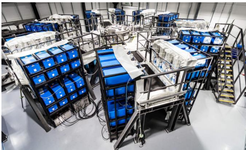
Figure 1 Machine 3 192 個のコンデンサに囲まれた真空チャンバー
