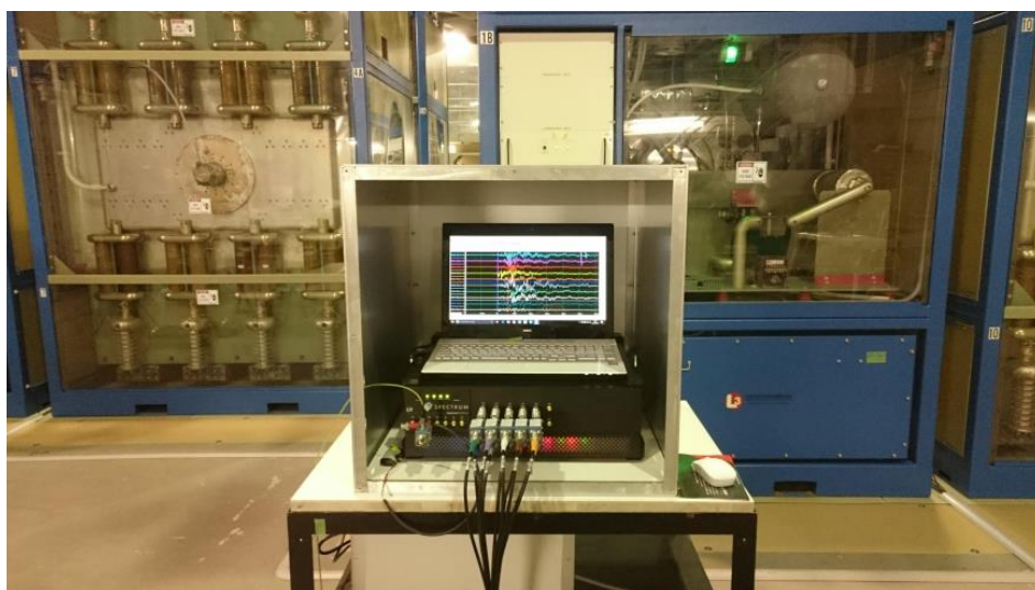
Figure 2 digitizerNETBOX は大きなコンデンサの近くに配置され、EMI を防ぐためにシールドされたエンクロージャに収容されています。 LXI 制御により、ノート PC またはラボネットワークへの接続を介して簡単に操作できます。
