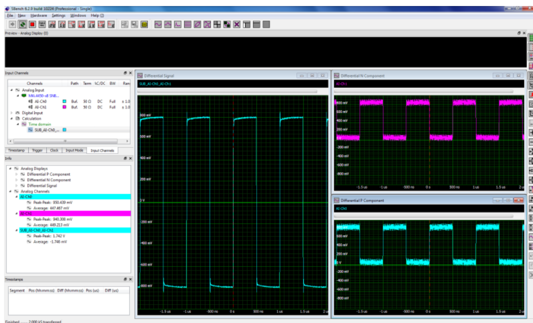
Figure 2 減算機能を使用して、2つの差動コンポーネントを差動信号に結合します。
