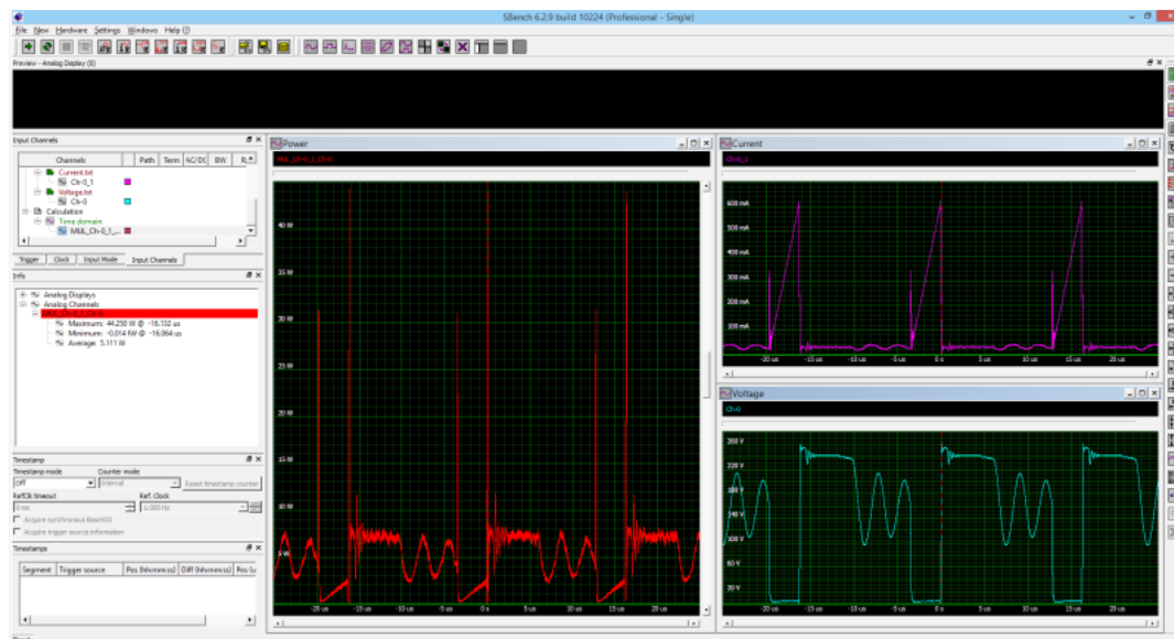
Figure 3 乗算機能を使用して、スイッチモード電源の電流および電圧波形から瞬時電力を計算します。
