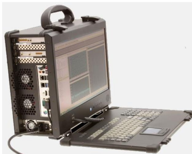
Figure 1 ポータブルコンピューターは、デュアル PCIe ベースのデジタイザのシャーシとして機能し、モバイルテストシステムを構成します。
