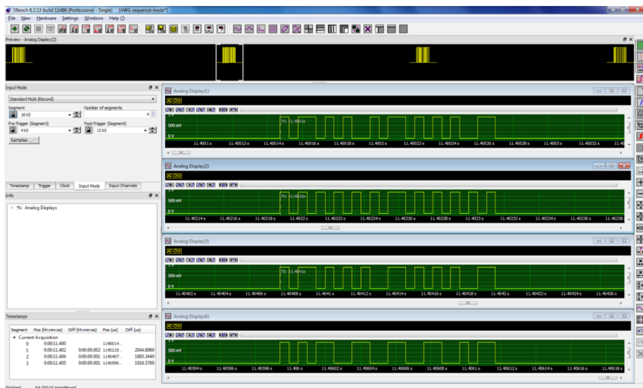
Figure 5 シーケンスメモリの内容を並べ替えた結果生じる4つの異なるデータパターン。これは、AWGの実行中に動的に実行できることに注意してください。
