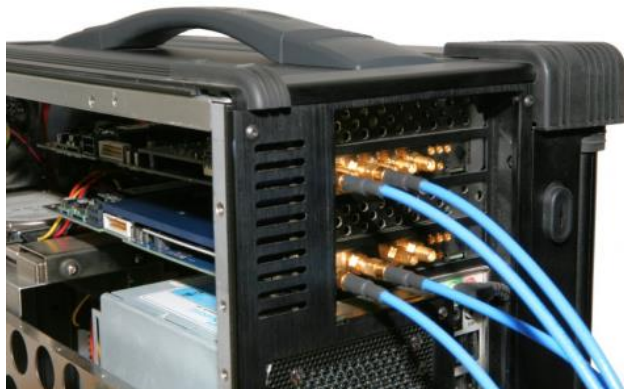
Figure 1 Spectrum M4i.4451-x8、500 MS/s、250MHz、14 ビットデジタイザと M4i.6631-x8、1.25 GS/s、400MHz、16 ビット、任意波形発生器で構成されるポータブルコンピュータに搭載された典型的なモジュラー刺激応答テストシステム。
