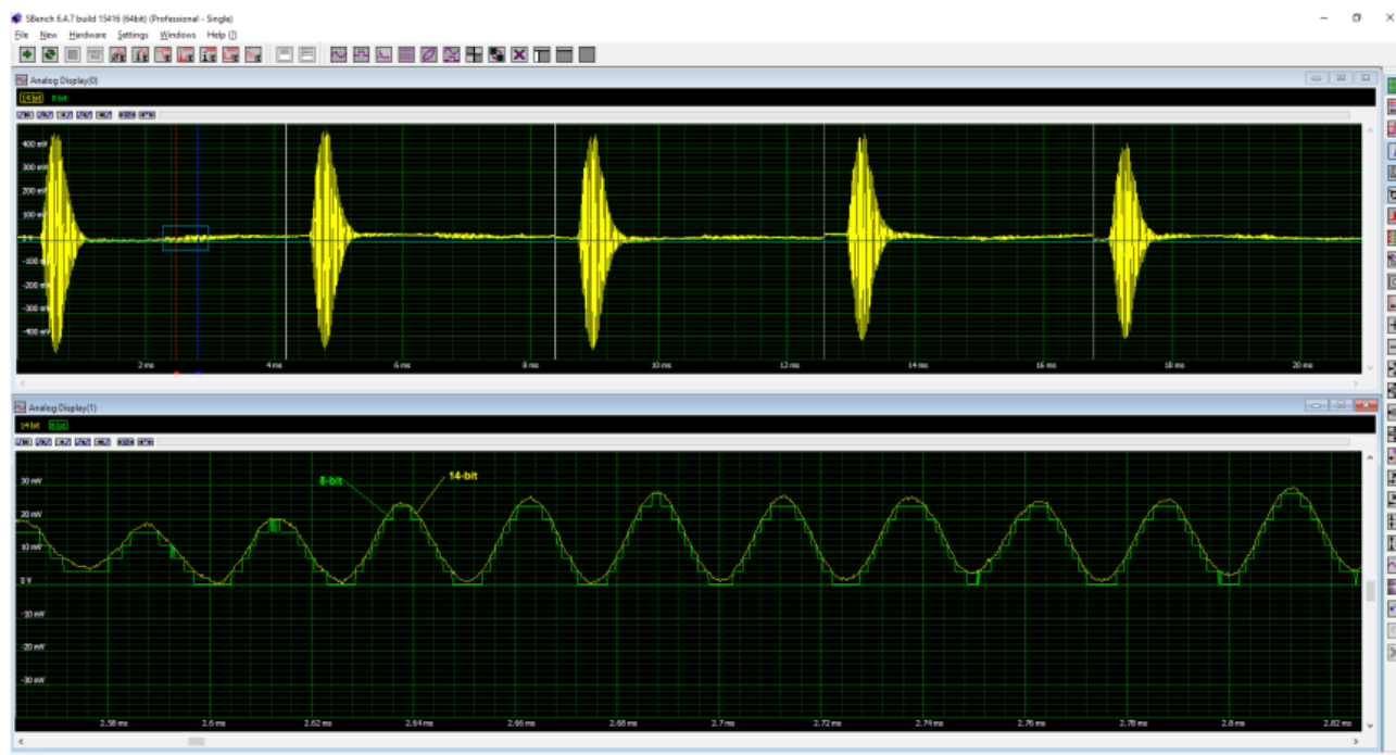
Figure 3 Spectrum M4i. 4451-x8 14bit デジタイザを使用して、超音波距離計に関連する信号を測定します。取得した信号は、Spectrum の SBench6 ソフトウェアを使用してグラフィカルに表示されます。
