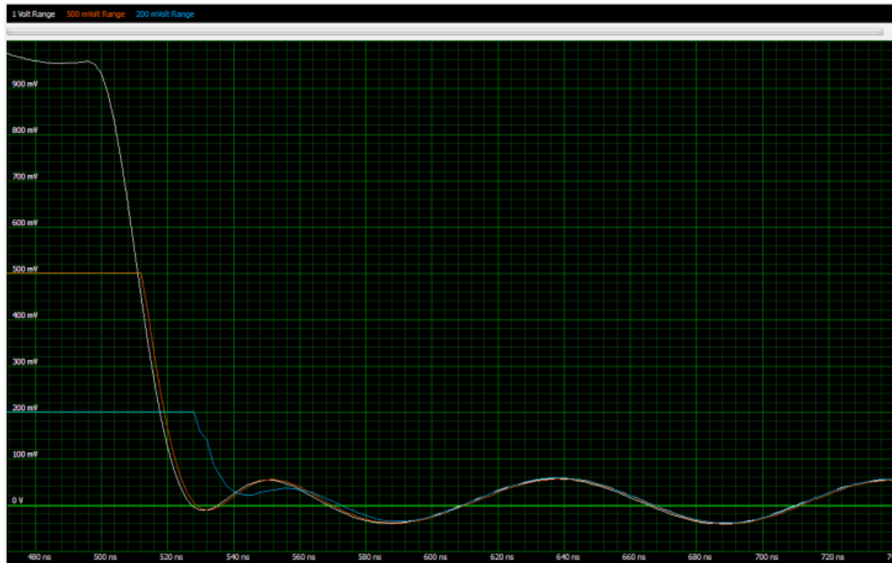
Figure 5 50 mV の正弦波で 1V の方形波に対する過負荷の影響を観察します。2 対 1 の過負荷時には、過負荷回復の遅延はほとんどありません。5 対 1 の過負荷では、大幅な過負荷回復遅延があります。
