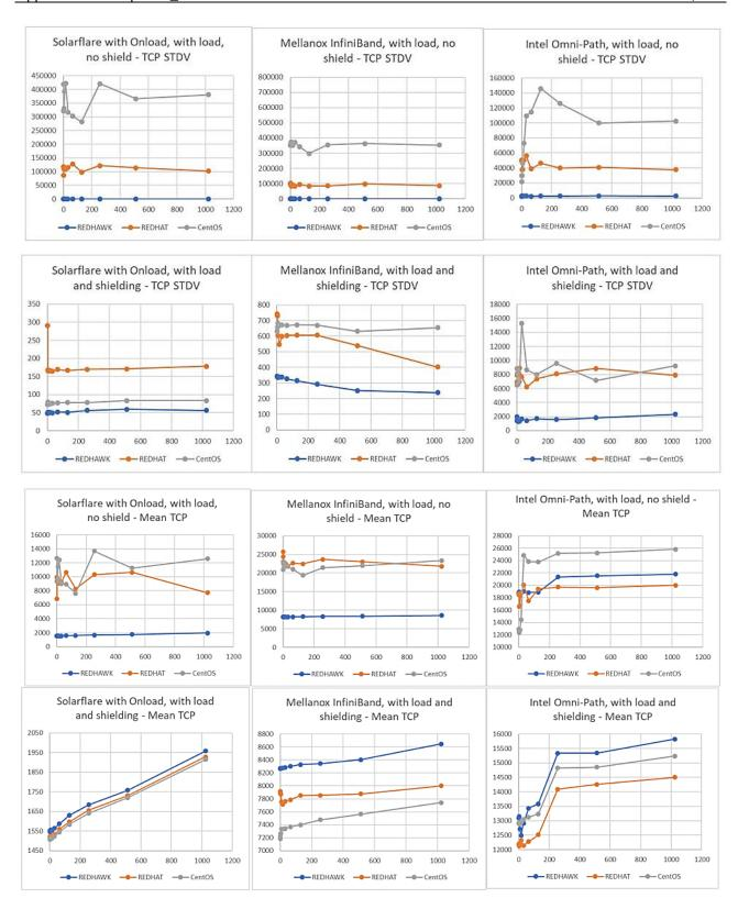
上のグラフは、パケットサイズをバイト単位で示しレイテンシ RTT/2 時間をナノ秒単位で示しています。システムに負荷があり、シールドがないインスタンスでは、RedHawk は、Solarflare 製および Mellanox 製 InfiniBand アダプターを実装するときに、比較的短い待ち時間を示します。シールドと負荷の両方が存在する場合、3 つのカーネルすべてが
