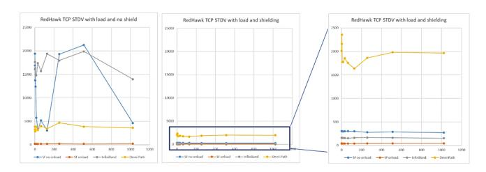
RedHawk は、同じ NIC 上の他のオペレーティングシステムと比較して、より優れたレイテンシ標準偏差値を示しますが、Onload を備えた Solarflare 製 NIC(オレンジ色)は他のネットワークアダプターよりもジッターを最も改善します。
