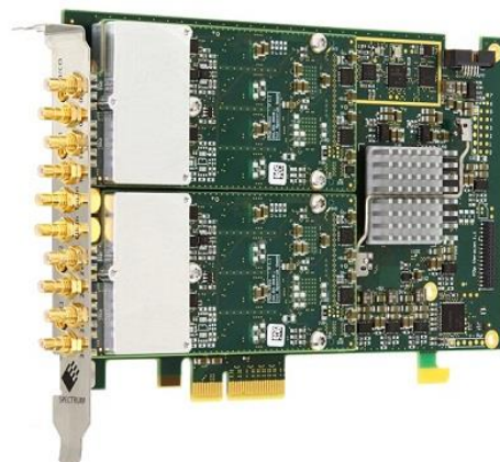
Figure 1 Spectrum 製 M2p-5926-x4 デジタイザ
