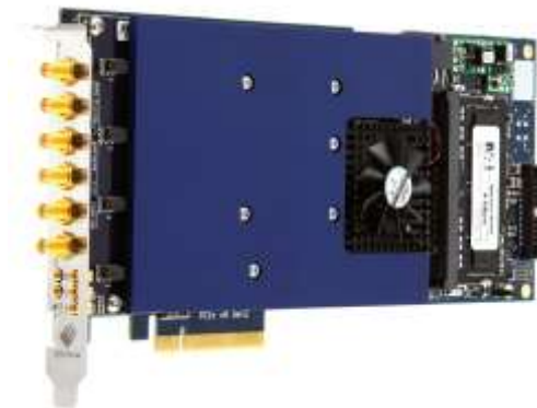
Figure 4 Spectrum 製 D/A ボード : M4i.6622-x8 4ch, 625MS/s
