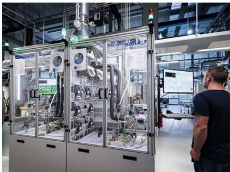
ZBTメインラボの2つの燃料電池テストステーション
