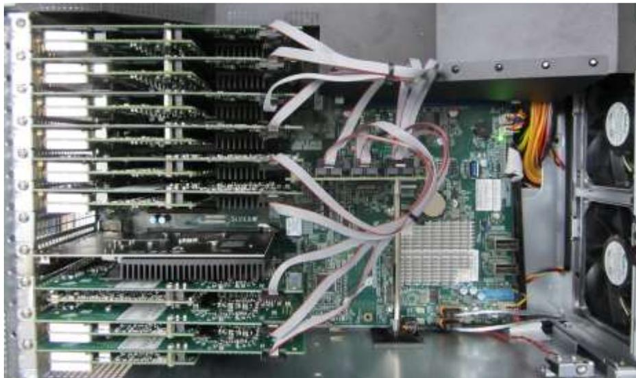
たとえば、6枚のM2p.5923-x4 A/Dボードを使用して、それぞれが最大20MS/sのサンプリングレートを提供する48chのシステムを構築できます。これは、MHz周波数範囲の信号を取得するのに最適な速度グレードであり、超音波イメージング、機械的測定、LIDAR、流体力学、地震研究、科学実験などのアプリケーションに最適です。
