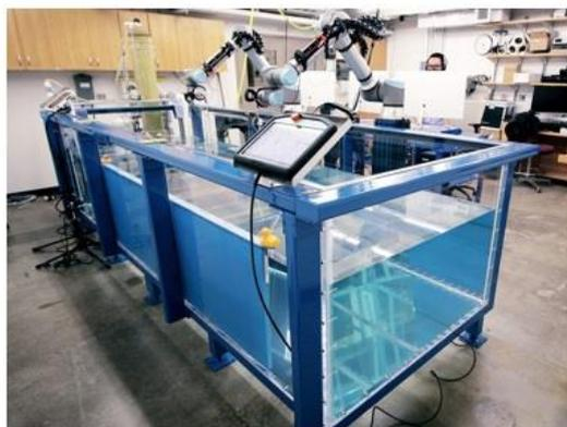
2本のロボットアームで送信機と受信機の位置を調整できる実験水槽
