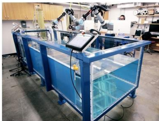
2本のロボットアームで送信機と受信機の位置を調整できる実験水槽
