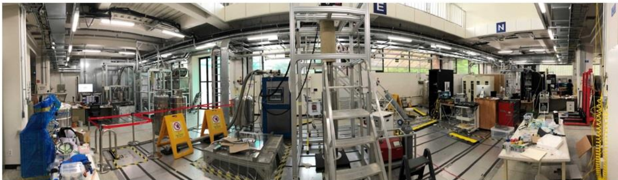
Figure 3: CAPP 実験ホールでは、複数の暗黒物質探索実験を設置して同時に操作することができます。実験室には、並列実験セットアップ用の7つの低振動パッドといくつかの冷凍機と超伝導磁石が含まれています。
