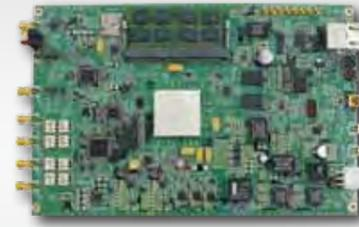
Xilinx社 Zynq 搭載高速 A/D & D/A ボード。AD は 2GHz 14bit 1ch、DA は 2GHz 16bit 4ch を搭載。
