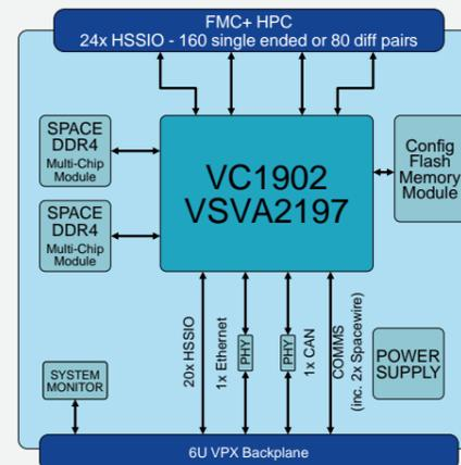
ADM-VA600 は、Space 2.0 向けの AMD-Xilinx Versal AI コア XQRVC1902 Adaptable SoCを搭載した6U Space VPX 評価プラットフォームです。Versal AI コアは、信号処理や機械学習などの計算集約型アプリケーションの宇宙ミッション向けに処理性能を大幅に向上させます。このプラットフォームは、LEO (地球低軌道) アプリケーションなど、放射線環境やミッションの長さが制限された Space 2.0 レベルのミッションに適した部品を使用できるように設計されています。ほとんどの部品は商用部品を使用しているため、ラボでのプロトタイプを作成することを目的としています。但し、このボードは、Texas Instruments 社と共同設計されたスペースグレード電源と、クロッキングおよびシステム監視機能をカバーするその他多くの Space Enhanced Plastic デバイスを搭載しています。近い将来、全ての部品をスペースグレードに置き換えた製品をリリースする予定です。
