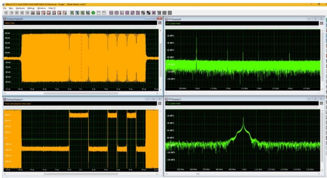
Figure 1 : 1 GHz 位相変調レーダーパルス (左上) と復調された位相情報 (左下)。パルスの周波数スペクトル (右上) とスペクトルの水平方向の拡大図 (右下)
