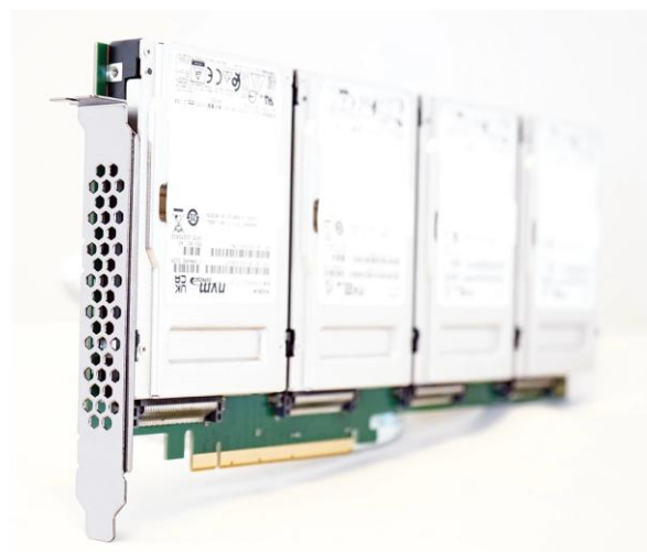
Figure10 : ドライブあたり 15 テラバイトをサポートする 4 つの Kioxia CD8 NVMe エンタープライズクラス SSD モジュールを搭載した PCIe-NVMe アダプタボード
