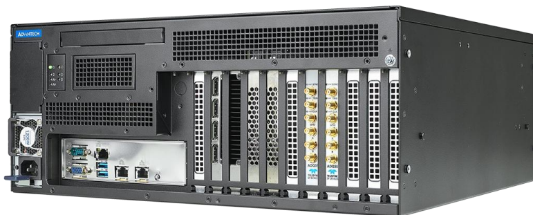
Figure11：書き込み速度 25GB/秒、合計ストレージ容量 75TB の 2 つの ADQ35-WB デジタイザーを使用した PCIe ベースの衛星監視システム
