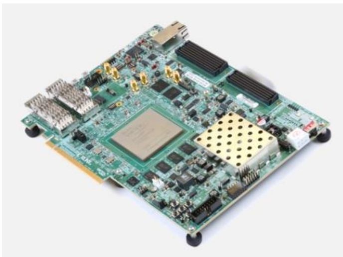
Figure 1 Xilinx VCU118 開発ボード。VCU118 には、Samtec FireFly™4 レーンソケットと 2 つの QSFP28 4 レーンソケットがあります
